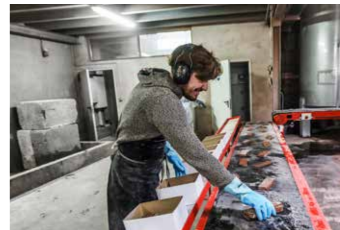
Die Herstellung gesägter und geklebter Klinkerriemchen
