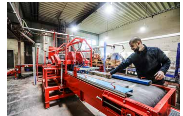
Die Herstellung gesägter und geklebter Klinkerriemchen
